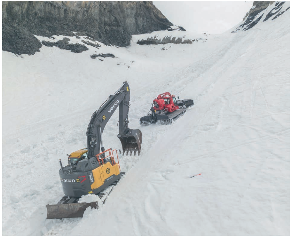
Das Pistenfahrzeug hilft: Die Bagger fahren über die steilste Skipiste auf den Berg. Foto: Marti Gruppe
